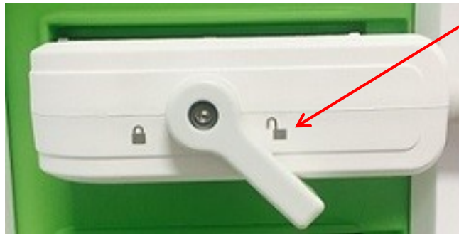
Kuva 11: Avattu anturin liittimen lukitussäädin avattuna
