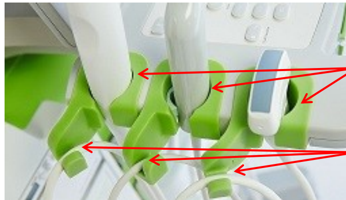
Kuva 16: Anturin/geelin pidikkeet ja kaapelinohjaimet
