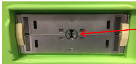
Kuva 9: Anturin liitäntäpaikan lukitusura
